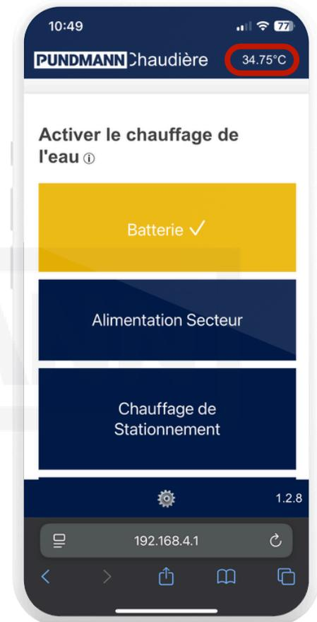
Si le **chauffage autonome Autoterm**, ou un autre chauffage stationnaire approprié **avec option de commande externe**, est **activé sur le troisième relais**, il s'allume automatiquement dessus.
